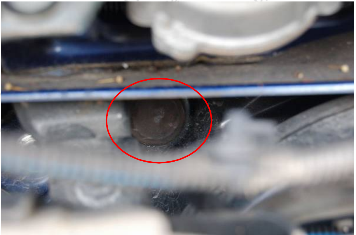
Blick vom Motorraum aus auf den Blindstopfen (Durchbruch), bei demontiertem Spritzschutz unterhalb der Frontscheibe.
